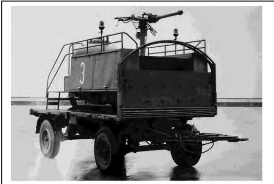
Kaessbohrer Typ: BWB 2300126 Pritsche 4t Pulver-Löschanhänger Aufbau: Total
