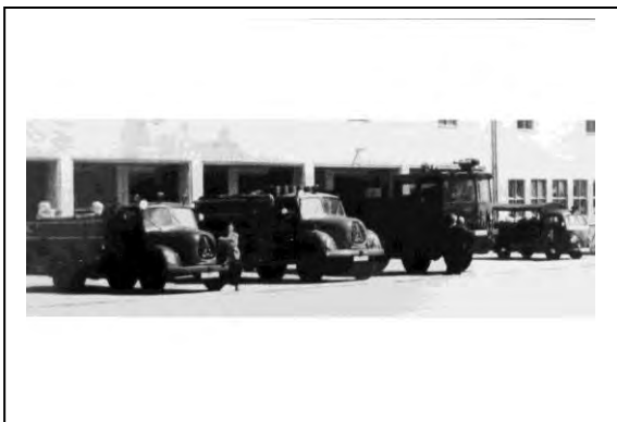
Magirus-Deutz S 3500A Feuerlösch-Kfz TLF 15-S7 Besatzung: 1+1 + 3 Einsatzkräfte a.d. Plattform Motor: 96kW/130PS 6Zyl. Diesel Antrieb: 4x4 Löschmittel: 1900ltr Wasser Eine größere Anzahl der Fahrzeuge wurde von der US AirForce 1957 der Bundeswehr übergeben und noch für einige Jahre im Bestand gehalten.
