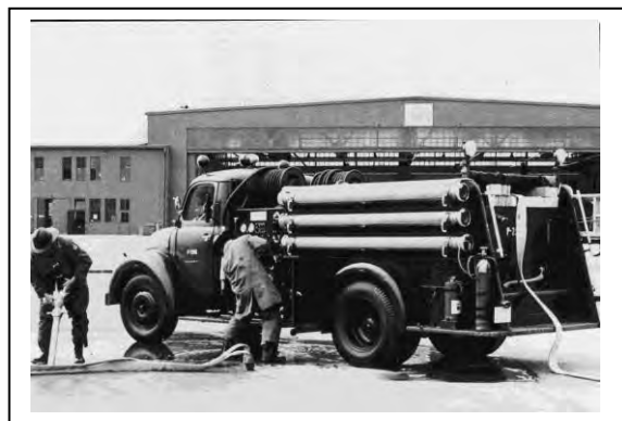
Magirus-Deutz S 3500 Feuerlösch-Kfz TLF 15-S4 Besatzung: 1+1 + 3 Einsatzkräfte a.d. Plattform Motor: 96kW/130PS 6Zyl. Diesel Antrieb: 4x2 Löschmittel: 1800ltr Wasser 200ltr Schaummittel Einige Fahrzeuge wurden von der US AirForce, speziell im Süddeutschen Raum von der Bundeswehr übernommen.
