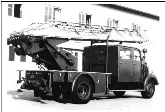
KHD Magirus-Deutz Mercur 125 Drehleiter DL25h Aufbau: Magirus Motor: 66kW/90PS Antrieb: 4x2 Das Drehleiter-Fahrzeug wurde Ende 1957 von der USAF/G auf dem FlgH Erding von der Bundeswehr übernommen und war noch einige Jahrzehnte im Einsatz. Derzeitiger Standort: Luftwaffenmuseum GATOW
