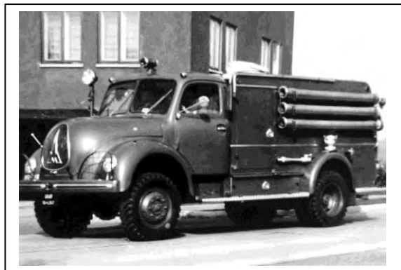
Magirus-Deutz S 3500A Feuerlösch-Kfz TLF 15-S7 Besatzung: 1+1 + 3 Einsatzkräfte a.d. Plattform Motor: 96kW/130PS 6Zyl. Diesel Antrieb: 4x4 Löschmittel: 1900ltr Wasser Eine größere Anzahl der Fahrzeuge wurde von der US AirForce 1957 der Bundeswehr übergeben und noch für einige Jahre im Bestand gehalten.
