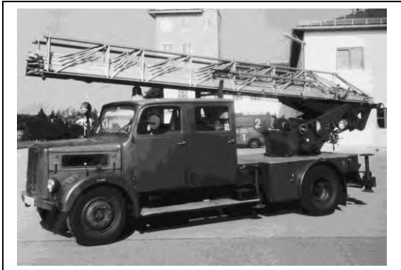
KHD Magirus-Deutz S 3500/DG24 Drehleiter DL22 Aufbau: Magirus Motor: 62kW/85PS Antrieb: 4x2 1950 wurde das Fahrzeug an die USAF/G ausgeliefert. Das Fahrzeug wurde 1957 von der Luftwaffe auf dem FlgH Neubiberg / München von der USAF/G übernommen.
