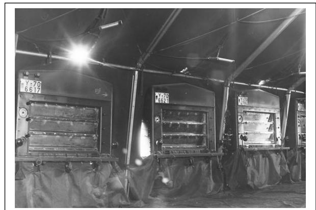
Diese Bild zeigt mehrere Feldbacköfen im Einsatz in einem Arbeitszelt. Leistung pro Backofen alle 80min 216kg Brot
