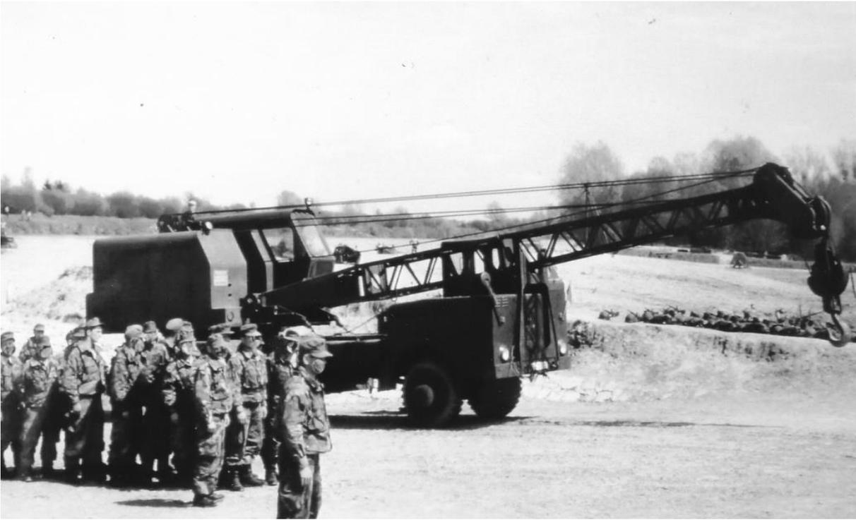
Autokran Firma DEMAG Typ B 406 mit DEMAG Kranaufbau vorgesehen u.a. zum Heben von SE-Brückenteilen oder anderen schweren Lasten beim Eisenbahnbau.
